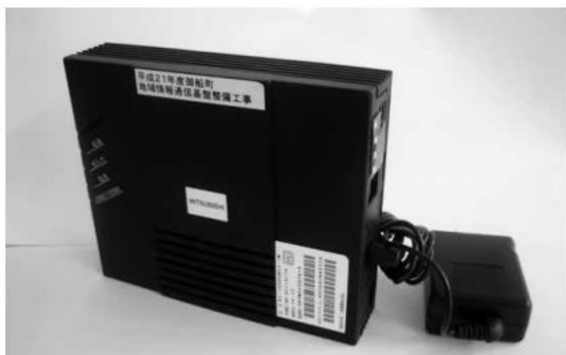
光回線の端末 ONU（宅内終端装置）
